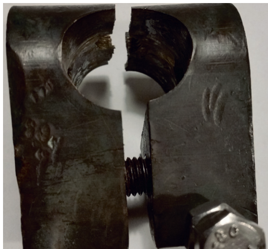
Bild 1. Mässingdetaljen som kläms fast och överför kraften från rorkulten till rodrets hjärtstock hade spruckigt i bakkanten.
